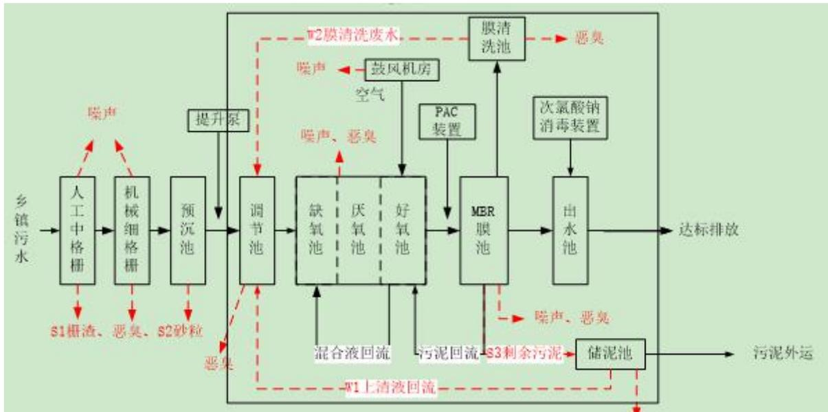
图 2-2 本项目工艺流程及产污环节示意图
